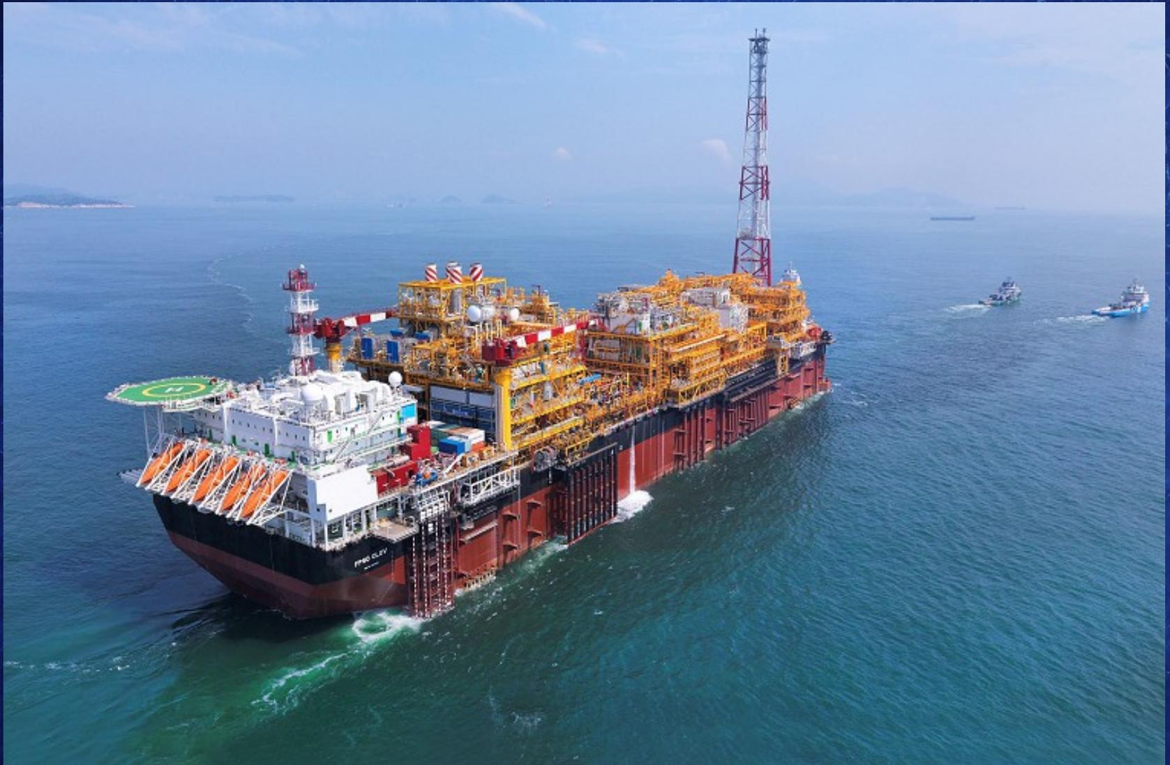
**Le tanker Kaombo Norte, aménagé en plate-forme pétrolière par le groupe Total au large de l'Angola. Le pétrole est extrait à 3500 mètres sous le bâtiment (2000 mètres d'eau + 1500 mètres de plancher sous-marin)**
