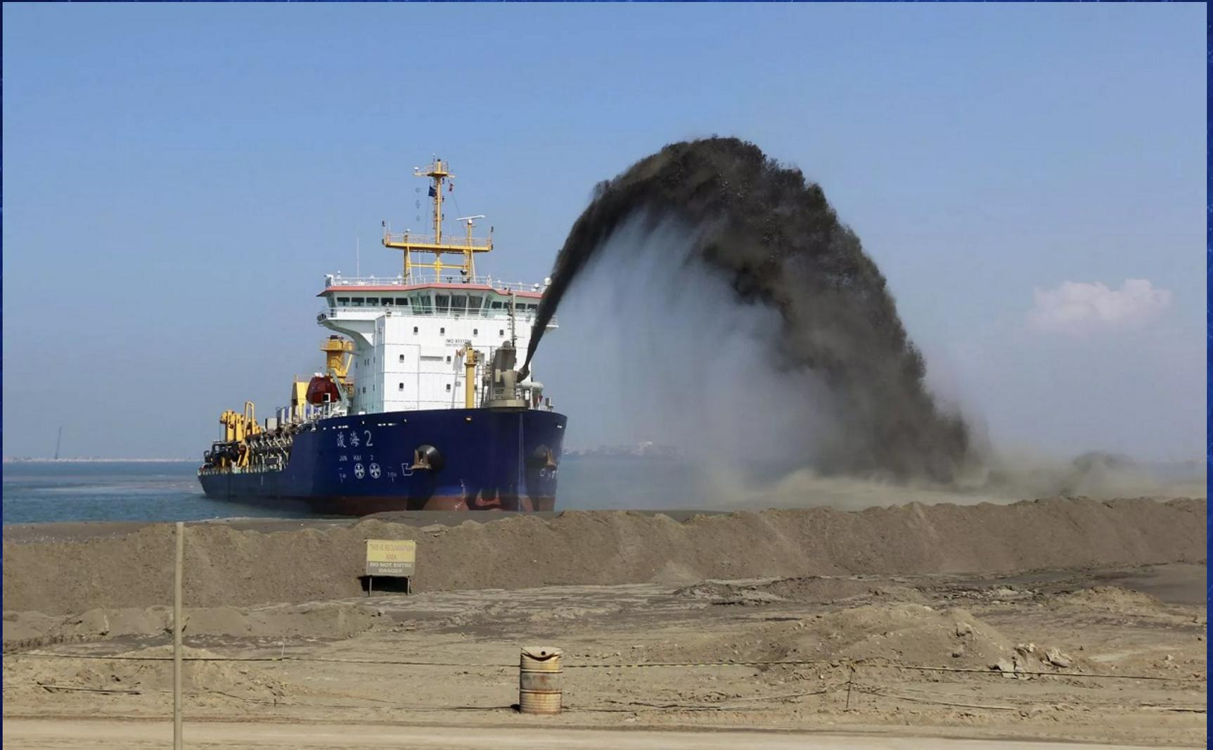
**Extraction de sable et de granulats au Sri Lanka par une drague**
