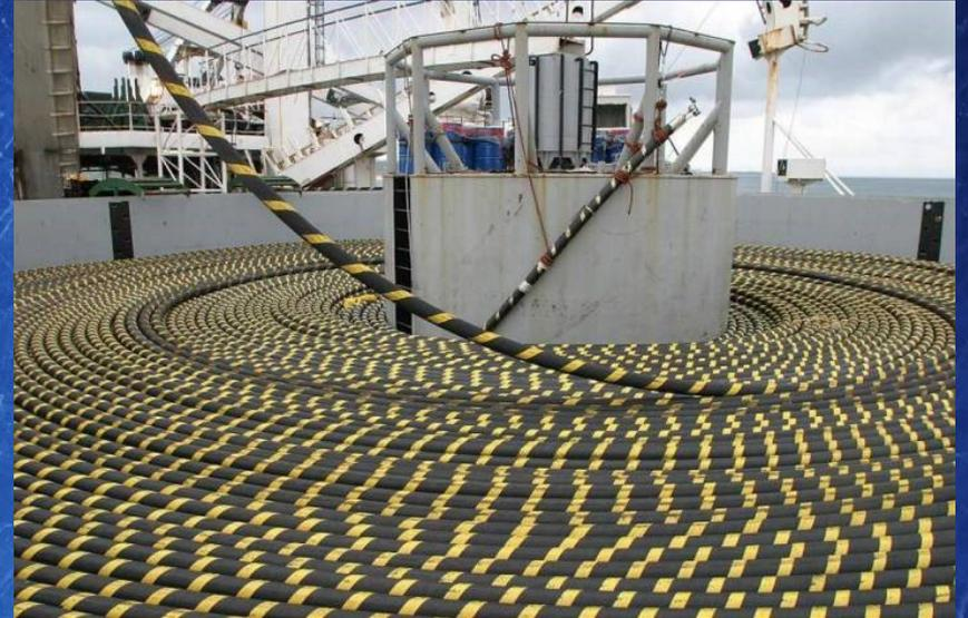
**Bobine de câble sur un navire câblé**
