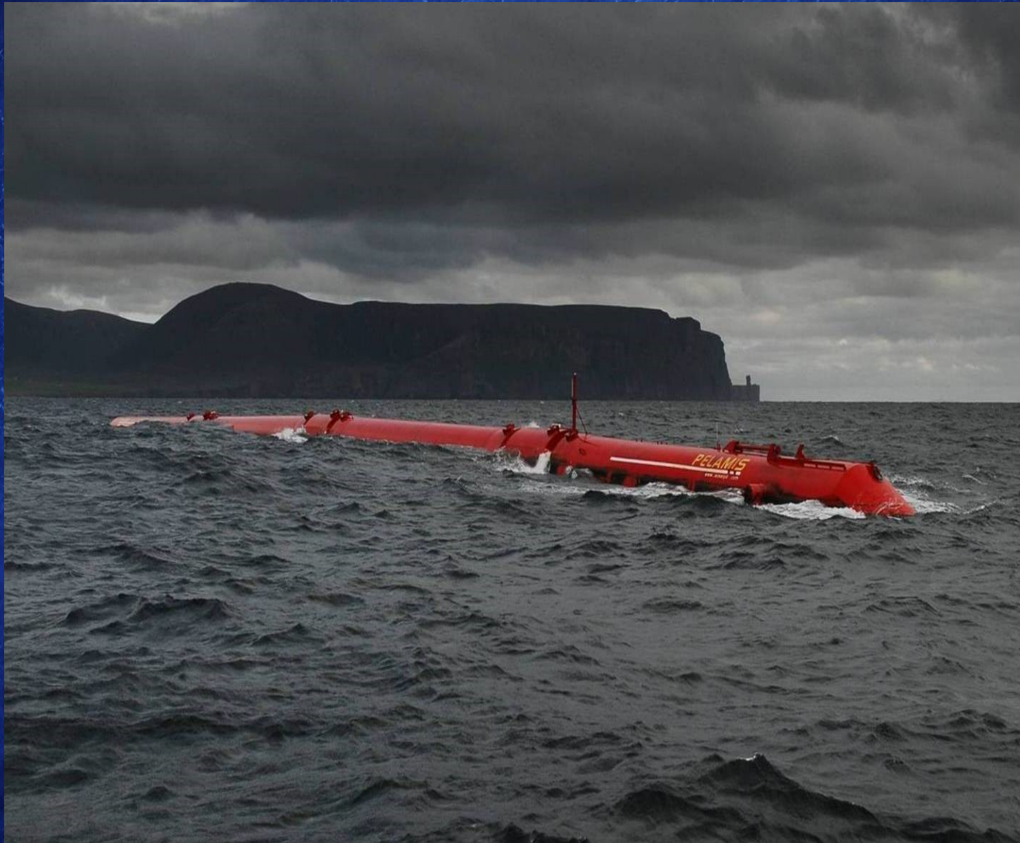
L'énergie houlomotrice produit de l'électricité à l'aide des ondes de surface qui traversent les océans Ici, une machine du projet Pelamis installée au large de la commune de Póvoa de Varzim au Portugal
